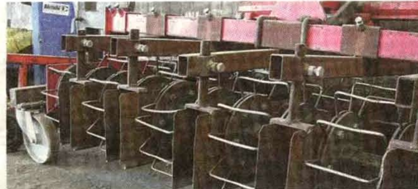
Mit dem Anbringen der Zwischenbleche wurde die Funktionsweise der Bügelhacke im Betrieb Schrader verbessert.
